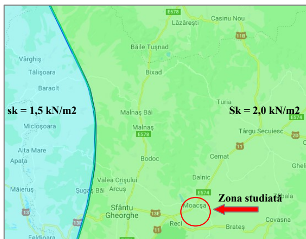
Figura 4. Încadrarea zonei cercetate în arealul de calcul a valorii încărcării date de zăpadă.
